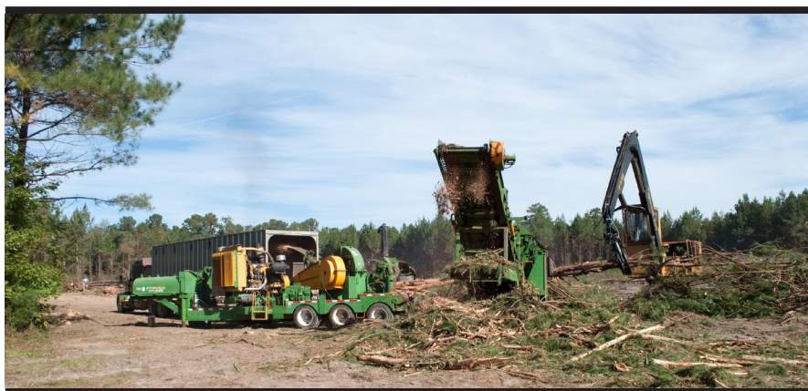
Figura 5. “Chipeadora” (alimentada por una cargadora) y furgón.
