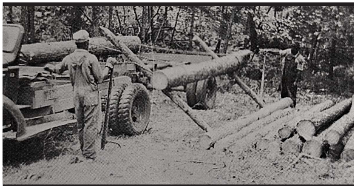
Figura 3. Carga de trozas aplicando el método de carga lateral.
