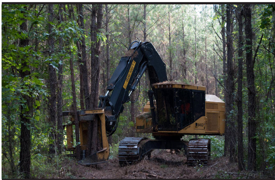
Figura 13. Feller-buncher “de área limitada” Tigercat 845D.
