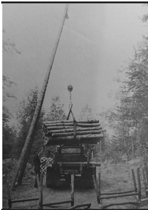
Figura 6. Carga de trozas utilizando una cabria en A instalada en el suelo.
