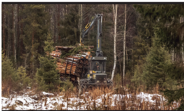
Figura 9. Forwarder Ponsse Bison extrayendo trozas largas.
